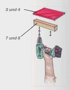
Schrauben Sie die Konsolen (3 und 4) mit den Auflagern (7 und 8) an der Rückwand (1) fest. Schrauben Sie die Kanthölzer (5) als Unterkonstruktion von hinten auf die Rückwand (1) (siehe Abb. 1). Drehen Sie die lackierte Seite der oberen Unterkonstruktion (5) nach unten. Verschrauben Sie die Tafel (2) mit der Unterkonstruktion (5), lassen Sie dabei zwischen den beiden Platten (1, 2) eine Fuge von ca. 1–2 mm. Nutzen Sie hierfür die 3,5 x 40-mm-Schrauben.
