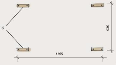
Schieben Sie das fertige Küchenbord über die Halter (6) und verschrauben Sie die Leisten von oben bzw. unten miteinander. Nutzen Sie hierfür die 4,0 x 50-mm-Schrauben.
