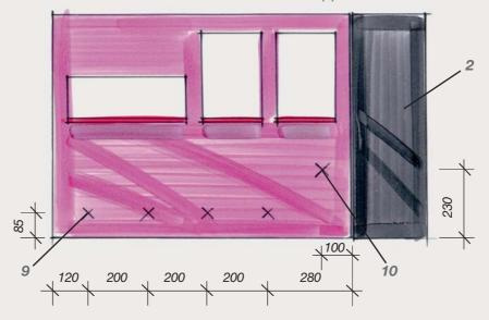
**7** Legen Sie jeweils eine Karosseriescheibe (24) unter und verschrauben Sie anschließend die Rohrschellen (9 und 10) mit der Rückwand (1). Nutzen Sie für die Besteckhalter (9) die 8 x 35-mm-Schlossschrauben und für den Halter der Gartenkralle (10) die 8 x 30-mm-Schraube.
